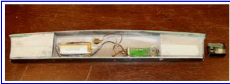
Obr. č. 3 – Detail elektronického skimmovacího zařízení pro čtení magnetické pásky platební karty 16
