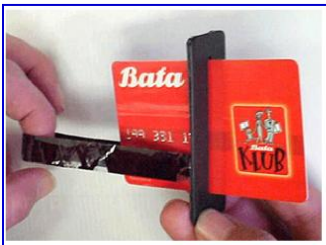
Obr. č. 7 - Přípravek na zadržení platební karty - tzv. „libanonská smyčka“ 23
