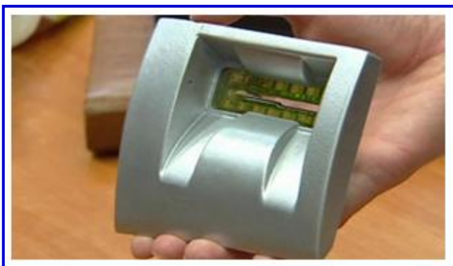
Obr. č. 2 – Falešná čtečka bankovních karet - nástavec na otvor bankomatu pro vložení karty, stejné barvy jako bankomat 15 .
